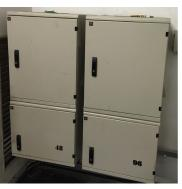
Gabinete estanco para poste o pared. Protección IP 54. Dimensiones Generales Con sobretecho: 450x665x235 (Nominales). Material: Chapa de acero SAE 1010 Terminación: Pintura al horno RAI7032 Puerta de acceso con doble cerraduras con codificación antivandalismo. Burlete elastomérico para cierre hermpetico.
